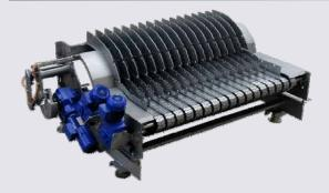
Flascheneinschub mittels Einfingersystem auf einer Kurbelschwinge.
